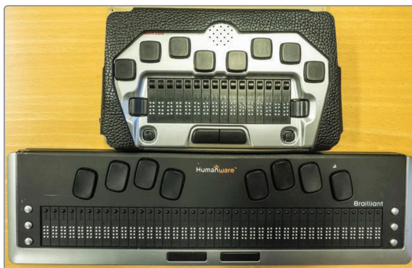
Figur 2 To eksempler på computere til læsning og skrivning via punktskrift. Kilde: acm5.com
